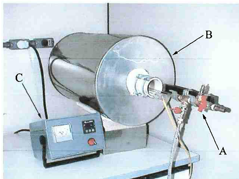
Figura 5 – Sistema de tratamento térmico com atmosfera dinâmica. (A) Dispositivo de atmosfera dinâmica com válvulas de realização de vácuo e de injeção de argônio; (B) Forno tubular; (C) Controlador de temperatura.
