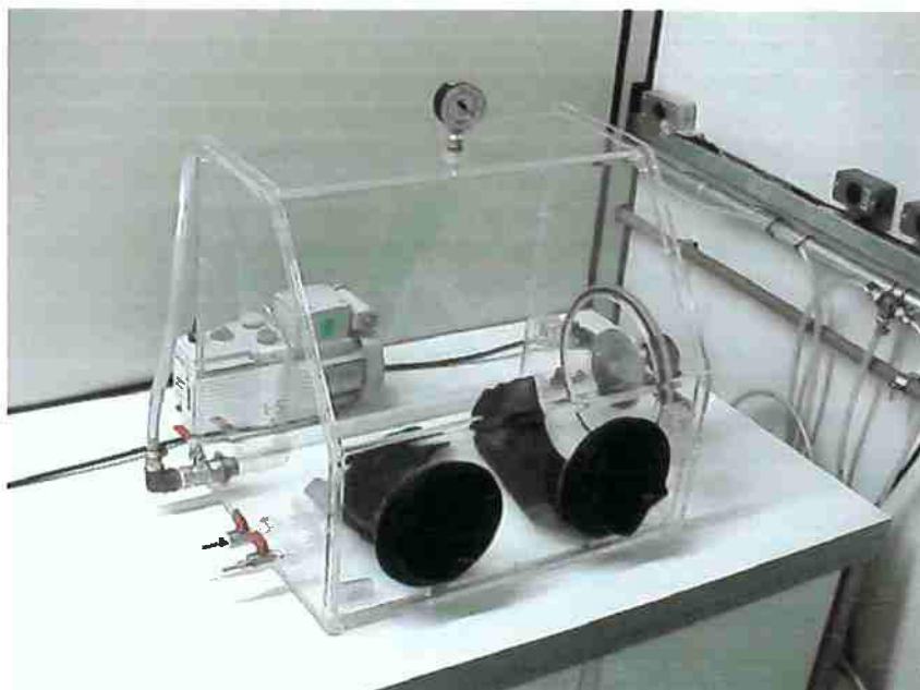
Figura 7 – Câmara do tipo glove box, situada no Laboratório de Moagem de Alta Energia
